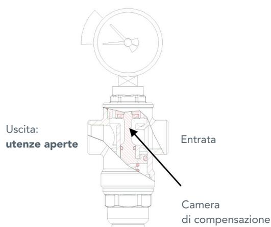
Quando le utenze da servire sono chiuse, la pressione a valle aumenta spingendo il pistone del riduttore verso il basso. In questo modo l'otturatore chiude la sezione di passaggio del riduttore mantenendo costante la pressione al valore di taratura, impostato sulla molla; la minima differenza di pressione esistente a cavallo dell'otturatore consente, infatti, la perfetta chiusura di quest'ultimo.
